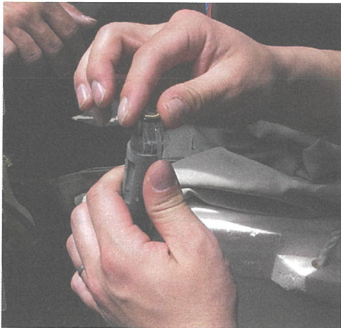
写真4 DO電極のチェック(DO電極中に気泡が無いことを確認)
