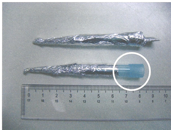
写真3 堆積物を採取するために用いているマイクロピペットチップ 上：アルミ箔で包んだマイクロピペットチップ 下：採取時にはアルミ箔の一部を剥離させて使用する (チップの根元(白円部分)をスパテラとして使用する)
