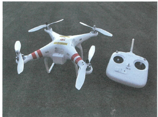
図8 DJI社製クアドコプターPhantomと専用送信機 (プロポ) (右) (井上ら, 2014)
